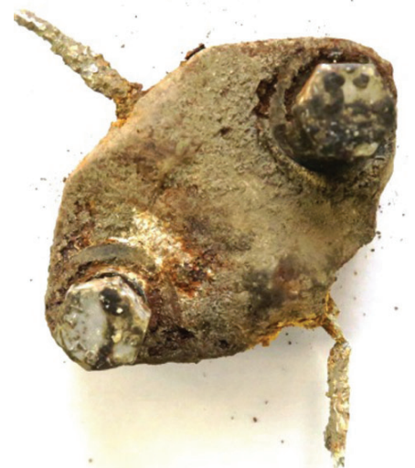
Bild 6 Unzulässige Verwendung von Aluminiumdraht im Erdreich.
